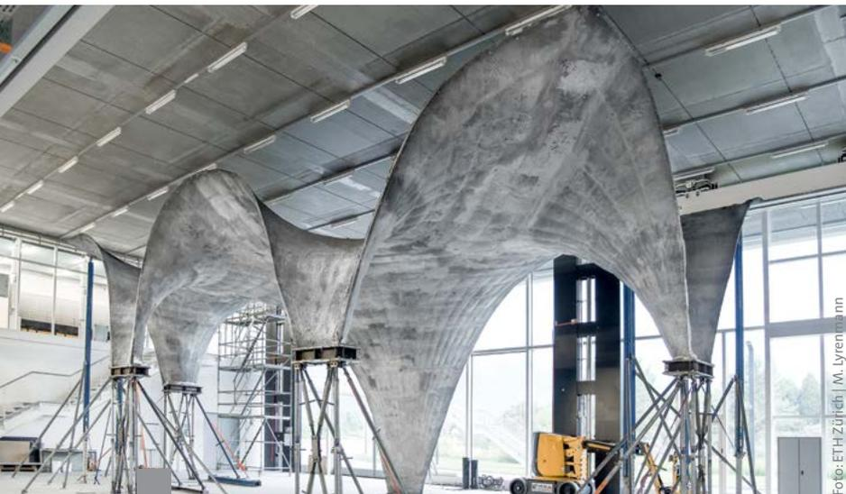
Diese innovative Dachkonstruktion wurde an einem 1:1-Modell erprobt. Das selbsttragende und doppelt gekrümmte Schalendach besteht aus mehreren Schichten, die Heiz- und Kühlschlangen, Dünnschichtsolarzellen und die Isolation enthalten.
